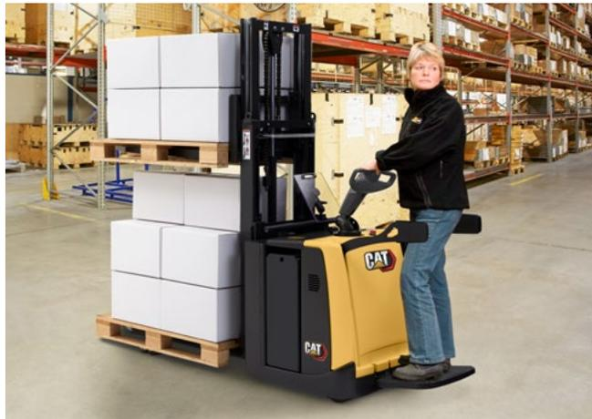
**Il transpallet elettrico per doppio pallet, con pedana ribaltabile, NPV20PD fa risparmiare tempo trasportando due pallet contemporaneamente (uno sopra l'altro). È perfetto per il doppio accatastamento sulle rampe di carico e per il trasporto di carichi in entrata e in uscita su brevi, medie o lunghe distanze.**
