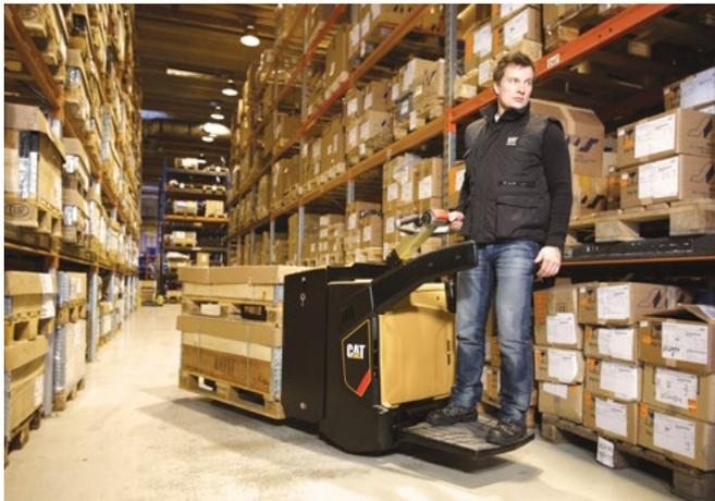
**Il modello NPV20N2 è una macchina con portata da 2 t estremamente efficiente adatta ad applicazioni mediamente o molto gravose, sufficientemente piccolo e manovrabile da poter essere impiegato a bordo dei veicoli che trasportano le merci. È dotato di pedana ribaltabile.**
