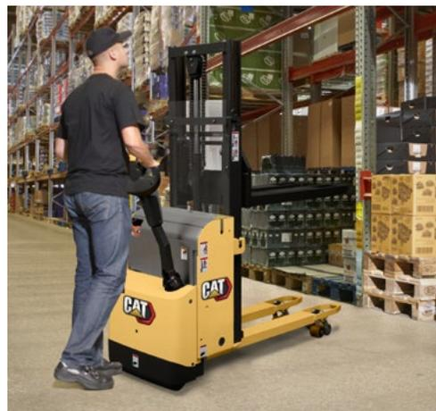
Il modello per doppio pallet condotto da terra NPP16PD fa salire la produttività poiché può trasportare due pallet contemporaneamente (uno sopra l'altro). È ideale per il carico e scarico su rampe di raccordo, prelievo e rifornimento, per trasporto di carichi su brevi distanze in magazzini, supermercati e aree di produzione.
