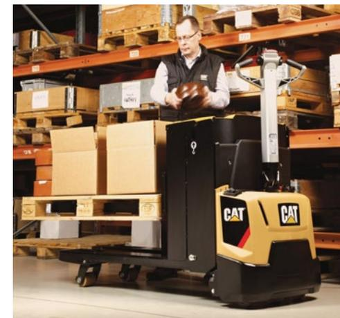
L'NPP20N2E è equipaggiato con forche di sollevamento (altezza 735 mm) che permettono una posizione ergonomica che richiede uno sforzo fisico minimo durante il caricamento e scaricamento delle merci.
