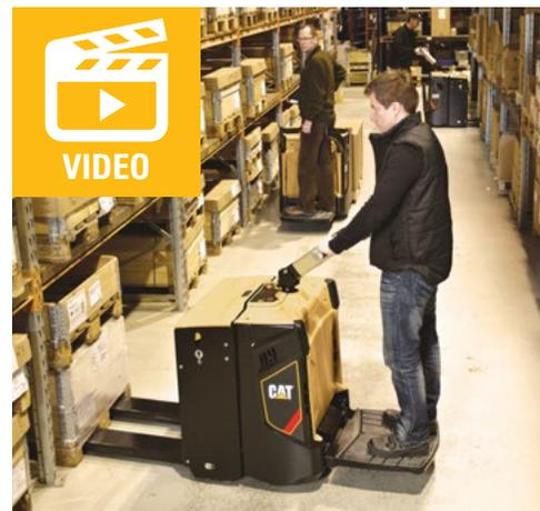
Il modello NPP20N2R è dotato di pedana ribaltabile per gli usi occasionali sulle maggiori distanze. La spaziosa pedana del modello NPP20N2R, dotata di ammortizzatori per rendere confortevole la corsa, permette di accedere e discendere facilmente ed offre anche una buona distanza libera da terra.
